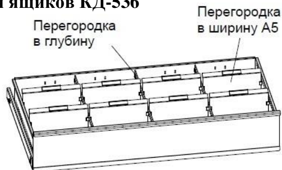
3xКД-516/536 Перегородка в глубину +8xКД-516/536 Перегородка в ширину А5 (четыре ячейки с шириной 229 мм)
